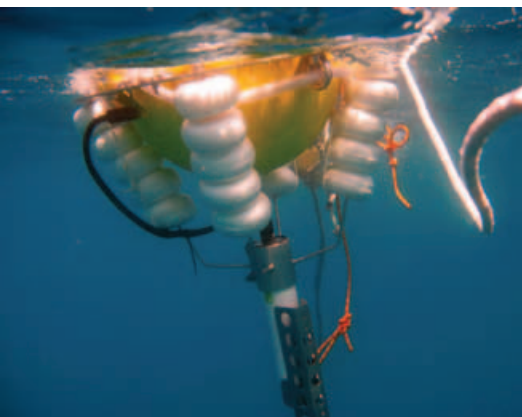
Una de las boyas SMOS desplegadas para medir la salinidad del mar.
